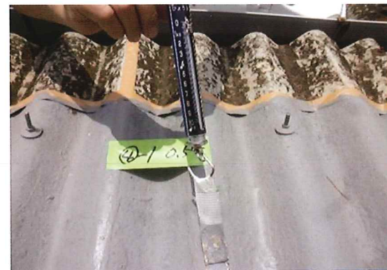
踏み抜き防止足場（メッシュロード）使用 ピーリング試験
